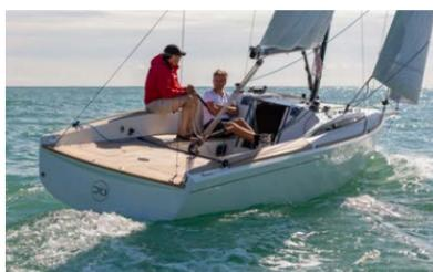
Die Domani S30 ist als Daycruiser konzipiert und erfüllt die entsprechenden Anforderungen: viel Potenzial auch bei wenig Wind. Mit 41 m<sup>2</sup> verfügt sie für eine Rumpflänge von nur 8,40 m (9,00 m sind es mit dem Bugspriet) über relativ viel Segelfläche. Gute Trimmöglichkeiten und insbesondere ein wirkungsvolles Achterstag helfen, das Optimum heraus zu holen.
