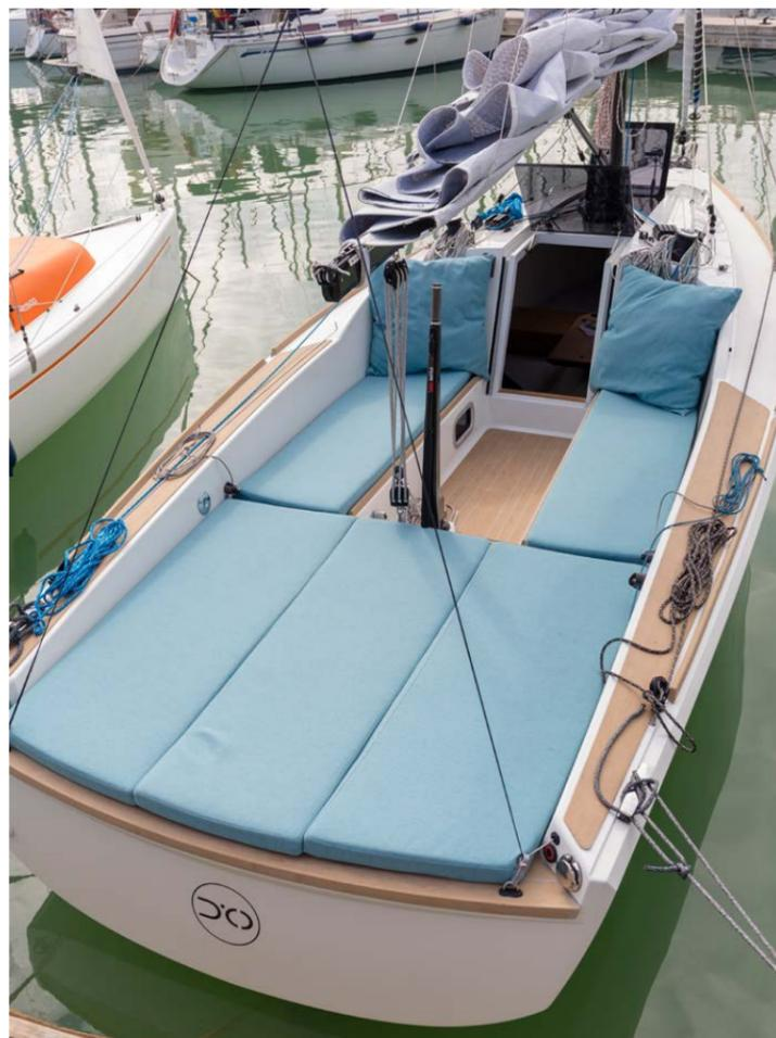
Die Grossschot kann problemlos vom Steuermann selber bedient werden und auch die auf dem Kajütaufbau geführte Fockschot befindet sich in Griffnähe. Einhandsegeln ist mit der Domani S30 also problemlos möglich. Noch mehr Spass bietet allerdings der Einsatz des Code Zero oder des Gennakers – wobei da eine weitere Hand sicher hilfreich ist.
